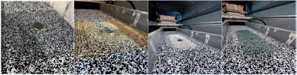
Fig. 2.4.2 Configurazioni esemplificative della protezione; da sinistra a destra: rete in plastica con maglia 10 mm e copertura quadrata di lato pari alla larghezza del canale, rete in gomma con maglia 10 mm e copertura quadrata di lato pari alla larghezza del canale, rete in gomma con maglia 7 mm e copertura rettangolare di larghezza inferiore alla larghezza del canale, rete in plastica con maglia 5 mm e copertura rettangolare di larghezza inferiore alla larghezza del canale.
