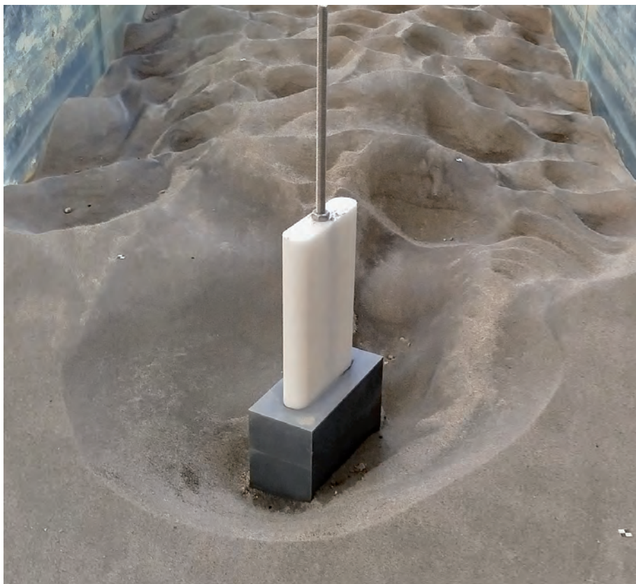
Figura 5.1 Scavo attorno alla fondazione di una pila allungata inclinata rispetto la corrente.
