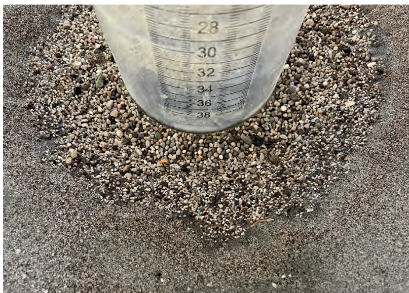
Figura 5.6 Esempio di evidenza di armoring nello scavo attorno ad una pila circolare.
